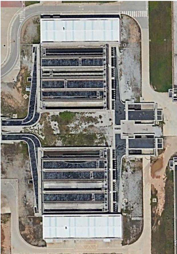
Imagen 2. Detalle desarenadores. Arriba lado BCN, abajo lado Prat
