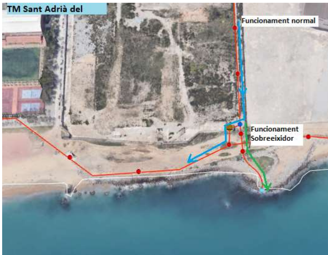
Il·lustració 4. Ubicació i funcionament sobreeixidor C.Procolor
